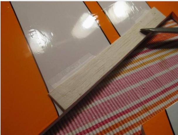
Zuerst wird ein 1mm dicker Balsastreifen mit Tesafilm bündig an der Hinterkante der Fläche befestigt.
