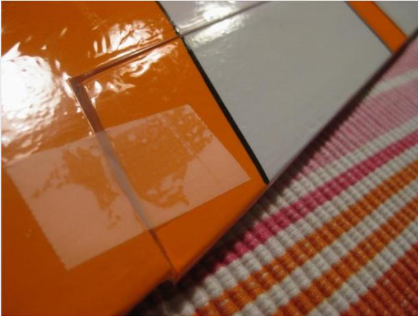
Anschließend klappen Sie die Ruder zurück und drücken die Naht leicht an. Fixieren Sie so die Ruder an den Seiten mit Klebestreifen.
