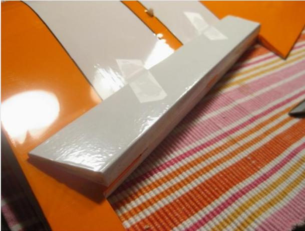
Nun wird das Ruder mit der Unterseite nach oben auf diesen Streifen gelegt und vorne mit Tesafilm fixiert.
